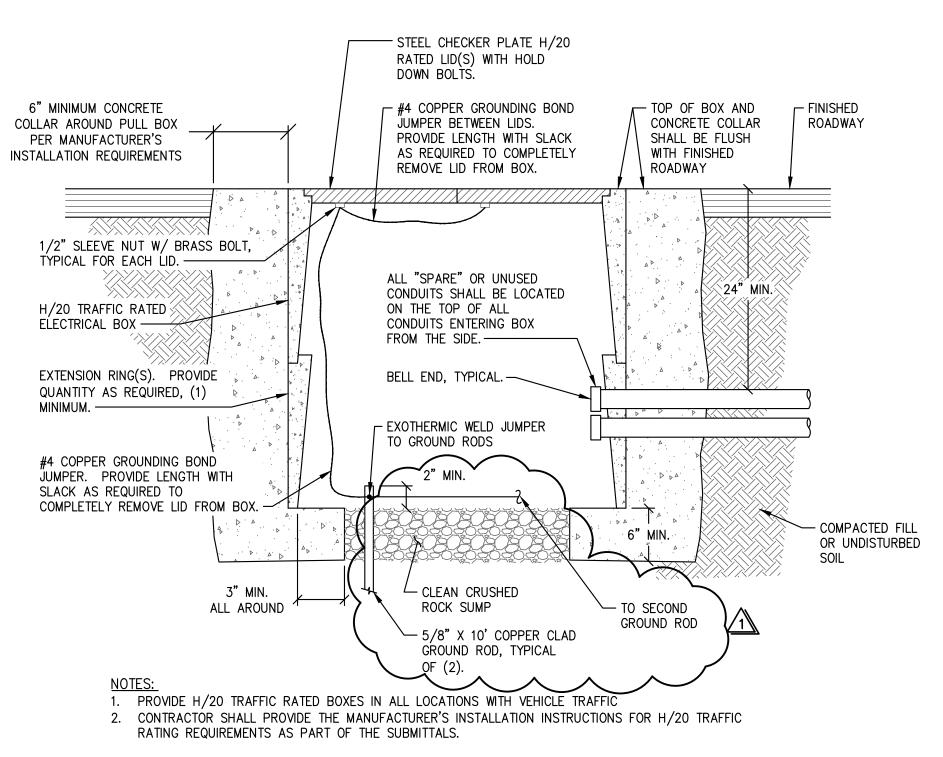
2 TYPICAL H/20 TRAFFIC RATED PULL BOX SCALE: NONE
